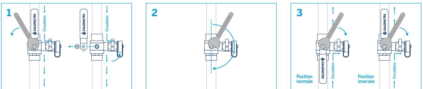
La valve à bille de Calefactio peut être rapidement et facilement reconfigurées pour se vider de l'autre côté en retirant la poignée et en tournant la tige de 180°.
